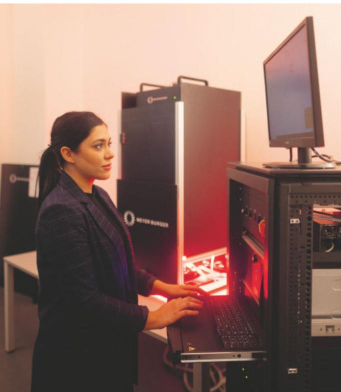
**Neuchâtel Sekunde der Wahrheit: Pasan-Geräte simulieren Sonnenlicht und messen die elektrische Leistung mit höchster Präzision.**
