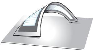
Dünnschichten zum Schutz von sensibler Elektronik vor Wasserdampf und Sauerstoff verdrängen zunehmend klassische Abdeckungen wie Glas. Die ausgezeichneten Schutzeigenschaften ermöglichen die Fertigung von dünnen, leichten und flexiblen OLED-Produkten, OPV-Modulen und Batterien. Mit der FLEx-Plattform bietet Meyer Burger (Netherlands) B.V. eine Dünnschichtbeschichtungsanlage, die den Anforderungen von morgen gewachsen ist, als integrierte Lösung oder als separates Prozessmodul.
