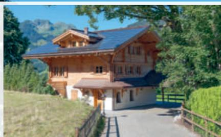
Sonnenenergie im alpinen Raum effizient genutzt: Im Dorfkern von Gstaad wurde ein neu gebautes Haus mit einer MegaSlate® Alpin Anlage ausgerüstet. Die Solarmodulanlage wurde von Meyer Burger hergestellt. Sie ermöglicht eine Leistung von 26 kWp und ist mit sechs integrierten und elektrisch bedienbaren Dachfenstern ausgerüstet. Dieses Gebäude ist eine perfekte Kombination aus umweltschonender Energienutzung und traditionellem Häuserstil.
