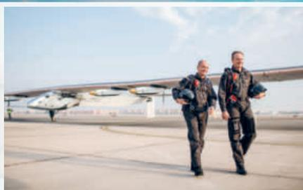
Visionen werden Realität: Meyer Burger war einer der offiziellen Ausrüster des Solar Impulse Projekts und hat einen wichtigen Beitrag zum Erfolg des Solar Impulse Teams geleistet. Für die erste Weltumrundung mit einem Solarflugzeug wurden 17 000 hocheffiziente Solarzellen durch Meyer Burger Technologie zu einem 269.5 m<sup>2</sup> grossen Flügelpanel verbunden.
